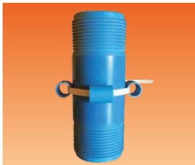
**CENTRADOR PLÁSTICO** para mantener la columna en posición central en la fase de descenso. Se compone de unidades individuales que se ajustan fácilmente: una abrazadera de fijación y tres pequeñas secciones de tubería de varios diámetros en función de las necesidades, equidistantes entre sí. Es una solución eficaz y económica.
