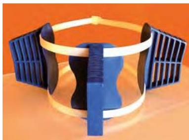
**CENTRADOR PLÁSTICO** para mantener la columna en posición central en la fase de descenso. Se compone de tres abrazaderas con aletas para que sea adaptable a los diferentes diámetros de la perforación. Las aletas, equidistante entre ellas, se pueden cortar para ajustarse a las dimensiones requeridas.
