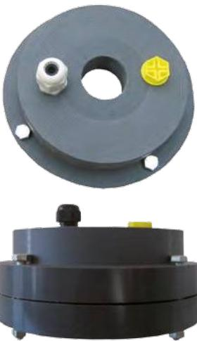
**TERMINALES DE PVC PARA EL CIERRE DE POZOS** con orificio central, tapón y pasacables. Los terminales constan de una brida y una contrabrida que se acoplan y aprietan con tornillos y pernos para garantizar la protección del pozo contra posibles contaminaciones.
