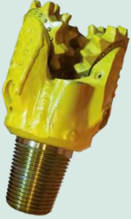
El **TRICONO** está compuesto por tres rodillos cónicos con dientes de acero, un rodillo o una esfera en carburo de tungsteno. Los más conocidos son los triconos con dientes de acero cortos o largos para terrenos blandos o de consistencia media y los triconos de carburo de tungsteno para terrenos duros o resistentes como la roca. El tricono puede comprarse nuevo o usado.
