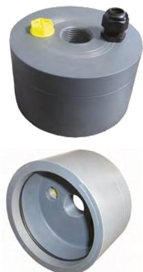
**TERMINALES DE PVC PARA EL CIERRE A PRESIÓN DE POZOS**, con orificio central, tapón y pasacables. Tienen un precio inferior al de los terminales de cierre normales, además de aplicarse más rápidamente dado que no presentan tornillos ni pernos. De todos modos, la aislación del pozo del ambiente externo está garantizada por una junta tórica de goma incorporada.
