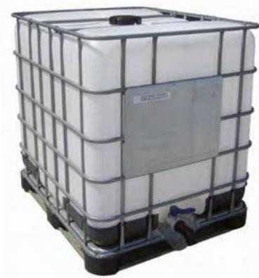
**TANQUE DE POLIETILENO DE ALTA DENSIDAD (HDPE)** para el transporte de líquidos, con estructura externa de metal dotada de entrada superior de Ø 135 mm cerrada con tapa y junta y de salida inferior de Ø 50 mm con grifo. Capacidad: 1000 l, medidas: 116,30 cm de altura, 120 x 100 cm de base. 116,30 cm, 120 x 100 cm de base.
