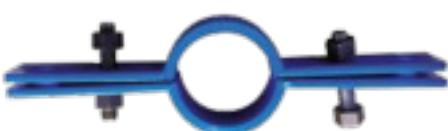
**ABRAZADERA DE ACERO** para sostener la columna en los tramos de descenso; se aplica a una distancia mínima de 300 mm del extremo abocardado del tubo para evitar la deformación de la rosca.
