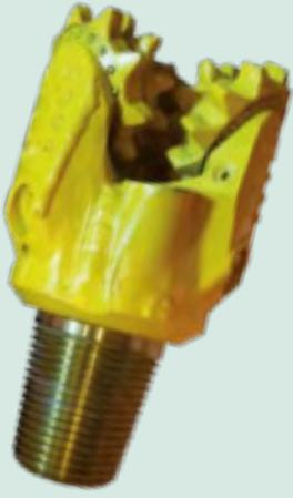
El **TRICONO** está compuesto por tres rodillos cónicos con dientes de acero, un rodillo o una esfera en carburo de tungsteno. Los más conocidos son los triconos con dientes de acero cortos o largos para terrenos blandos o de consistencia media y los triconos de carburo de tungsteno para terrenos duros o resistentes como la roca. El tricono puede comprarse nuevo o usado.
