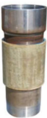
**UNIÓN DIELÉCTRICA**. Es fundamental para garantizar el aislamiento eléctrico permanente entre los distintos materiales de los tubos que componen la columna (por ejemplo acero inoxidable y acero al carbono), además de proteger la parte inferior de la columna contra las eventuales corrientes parásitas.
