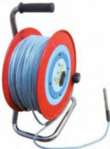
**SONDA DE NIVEL PORTÁTIL** para la medición de napas en pozos, piezómetros, etc. El instrumento consta de un cable centimetrado de 100 metros de longitud con punta de acero inoxidable 304 de Ø 12 mm, así como de un bobinador, un asa para el transporte y una placa electrónica con indicador acústico y luminoso de agotamiento batería.
