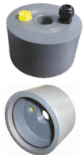
**TERMINALES DE PVC PARA EL CIERRE A PRESIÓN DE POZOS**, con orificio central, tapón y pasacables. Tienen un precio inferior al de los terminales de cierre normales, además de aplicarse más rápidamente dado que no presentan tornillos ni pernos. De todos modos, la aislación del pozo del ambiente externo está garantizada por una junta tórica de goma incorporada.
