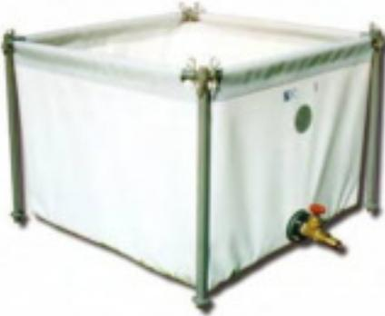
**DEPÓSITO FLEXIBLE PARA LÍQUIDOS**, constituido por una bolsa de tejido poliéster extrafuerte revestido con plastómeros y sostenida por un bastidor metálico de fácil ensamblaje. Capacidad de 1m<sup>3</sup> a 60 m<sup>3</sup> según las dimensiones (véase tabla abajo). Cuando no se utiliza, el depósito puede plegarse para ocupar el mínimo espacio.
